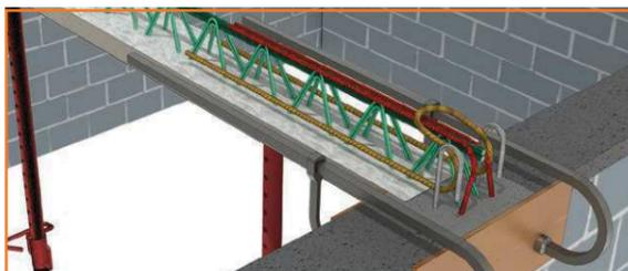
**5** Coffrage + clavetage de la poutre.
